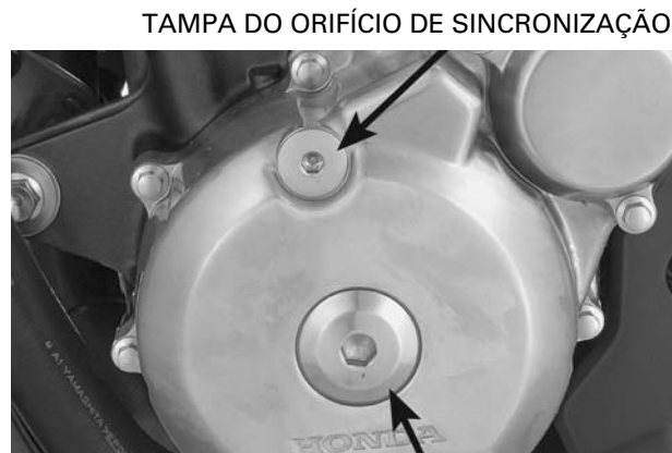
TAMPA DO ORIFÍCIO DE SINCRONIZAÇÃO TAMPA DO ORIFÍCIO DA ÁRVORE DE MANIVELAS
