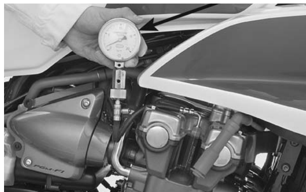
MEDIDOR DE COMPRESSÃO
