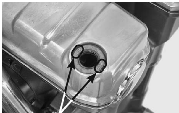
MARCAS "UP" PARAFUSOS/ARRUELAS
