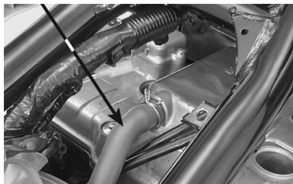
MANGUEIRA DE RESPIRO DA CARÇA DO MOTOR
