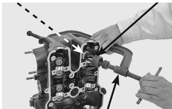
COMPRESSOR DE MOLA DA VÁLVULA
