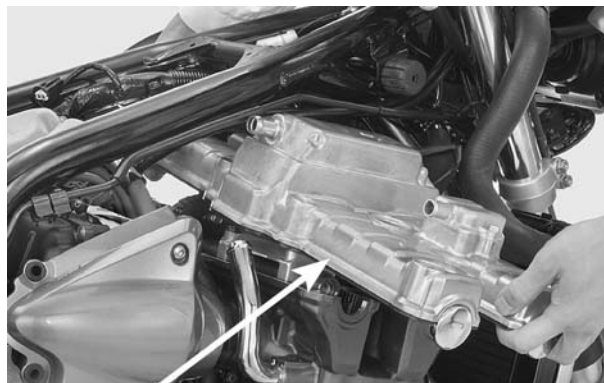
TAMPA DO CABEÇOTE JUNTA
