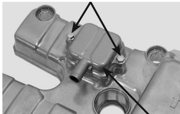
TAMPA DAS VÁLVULAS DE INSPEÇÃO PAIR JUNTA
